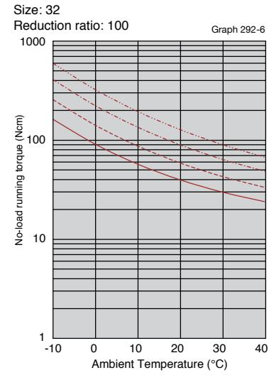
Input rotational speed ————— 500rpm   ----- 1000rpm   ----- 2000rpm   ----- 3500rpm
