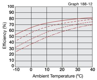
Input rotational speed      ————— 500rpm      - - - - - 1000rpm      - - - - - 2000rpm      - - - - - 3500rpm
